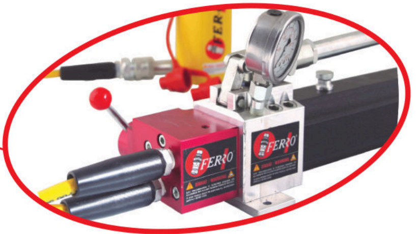
4 Yollu 3 konumlu kontrol valfi 4-Way 3-positioned control valve
